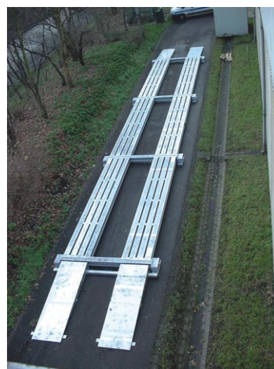
18m Fahrzeugwaage mit Rampen
